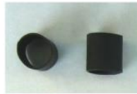
ろ過ろ材:円筒径、φ15±1mm、 比重0.96
